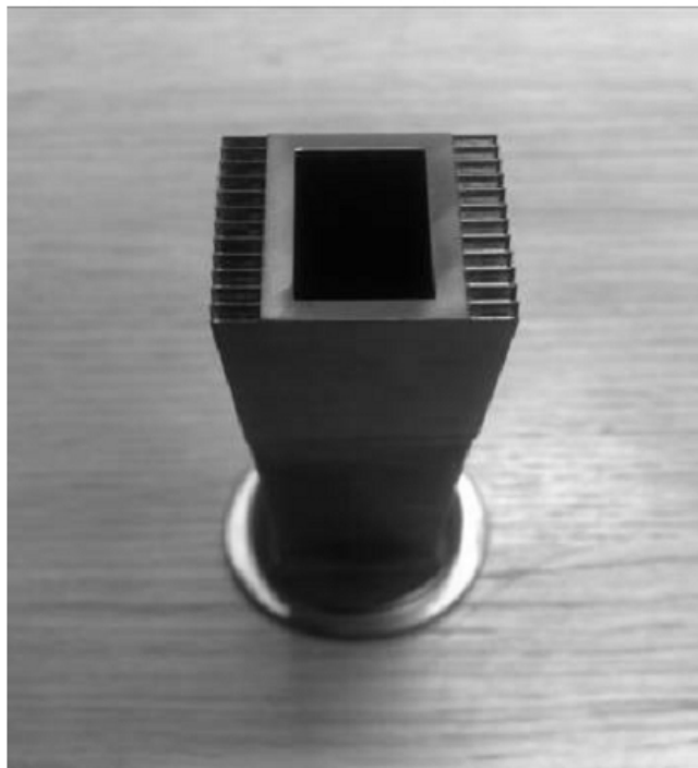
Slika 3: Trn za izdelavo elementa za zaklep volanskega mehanizma
